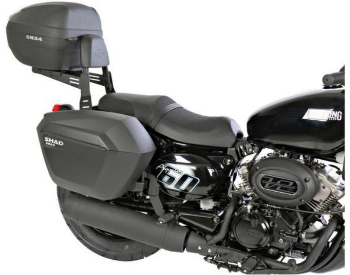
SHAD Sissybar/Topcaseträger/Seitenkofferträger mit 3P System
